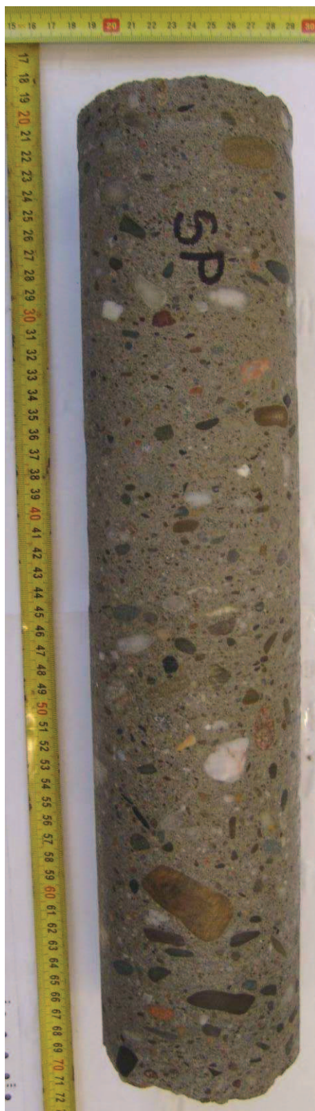
FOTO 2 – Celkový pohled na dodaný jádrový vývrt SP (sklep – patka), dokumentace struktury betonu
